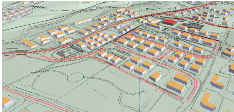
Figura 6:3 - - Modello dell'area di studio 3D in Soundplan ( Stato Futuro )
