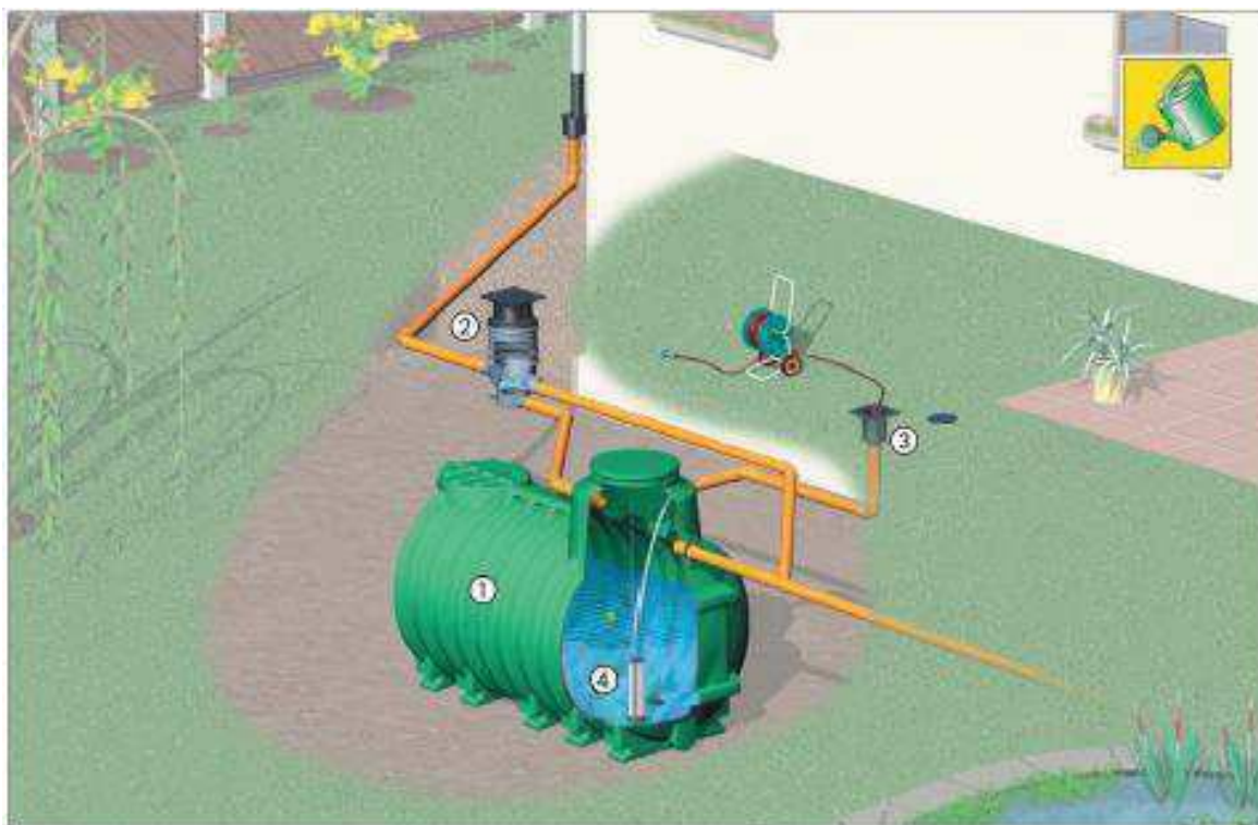
Figura 4.1 – Sistema di recupero delle acque meteoriche
