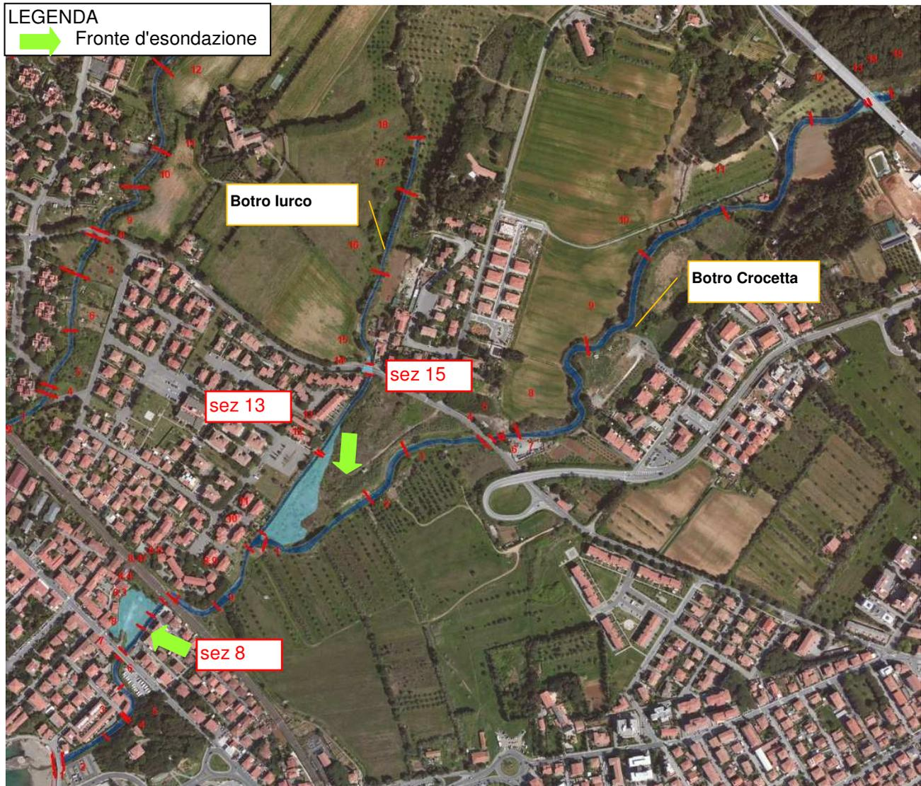
Figura 7-4: planimetria dei botri lurco e Crocetta oggetto di studio con l'indicazione dei fronti di esondazione.
