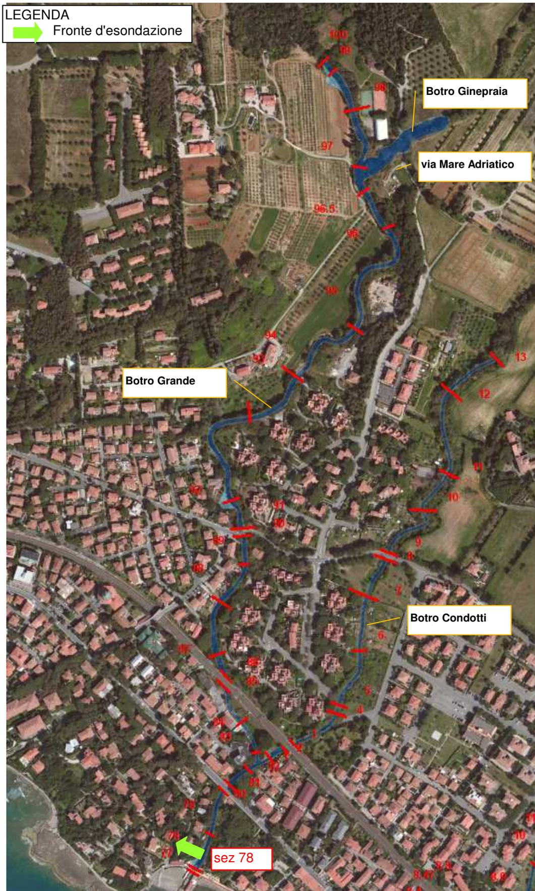
Figura 7-3: planimetria dei botri Grande e Condotti oggetto di studio con l'indicazione dei fronti di esondazione.
