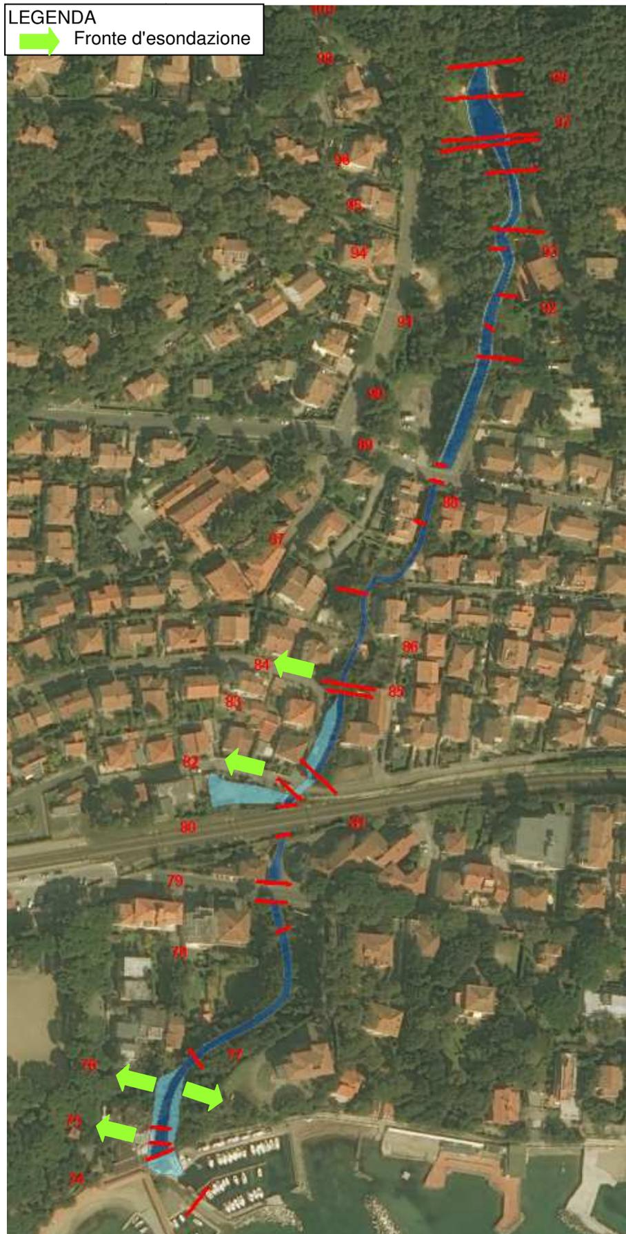
Figura 7-2: planimetria del tratto del botto delle Acacie oggetto di studio con l'indicazione dei fronti di esondazione.
