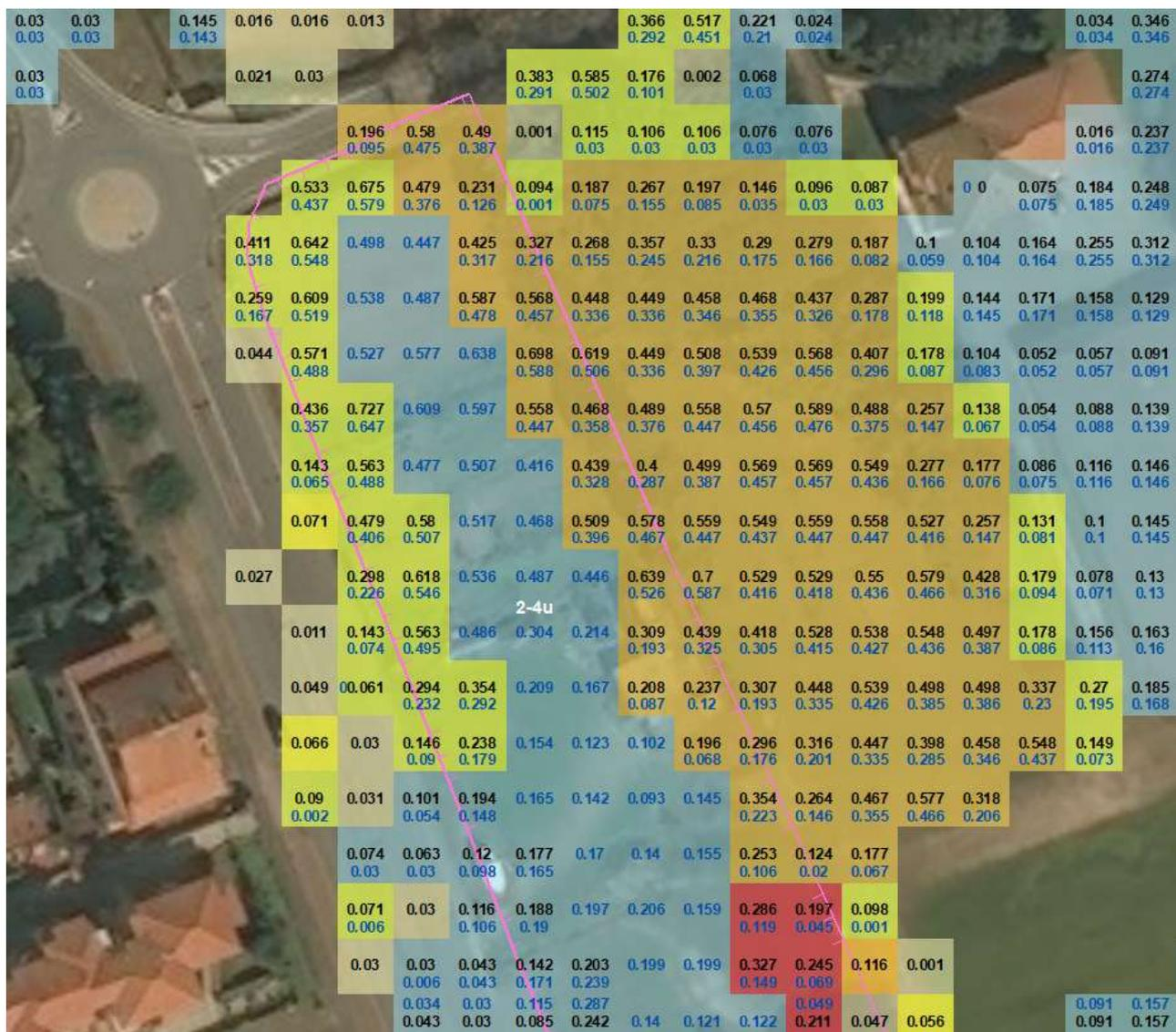
Figura 10-23: Perimetro del comparto 2-4u (Area a Nord) e indicazione delle celle di calcolo con i valori di battente (espresso in metri) nelle configurazioni di progetto (valori di colore nero) e di stato attuale (valori di colore blu).
