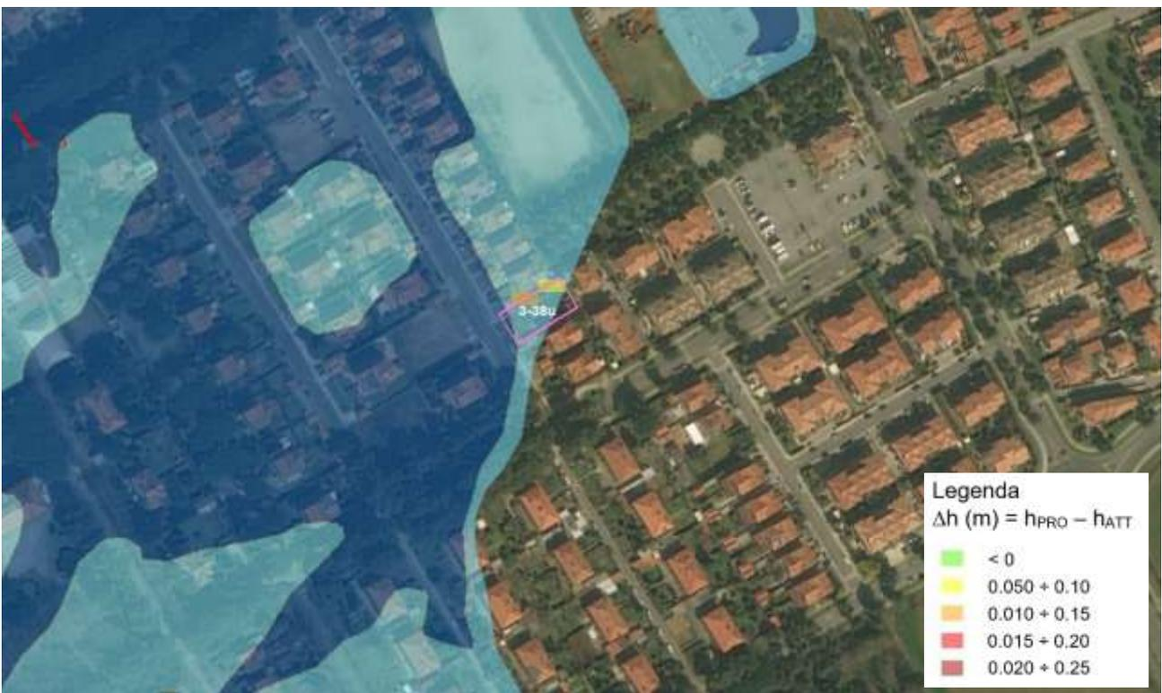
Figura 10-14: Perimetro del comparto 3-38u e indicazione delle celle di calcolo in cui si è calcolato un incremento di battente idraulico nello scenario di progetto rispetto allo scenario di stato attuale.
