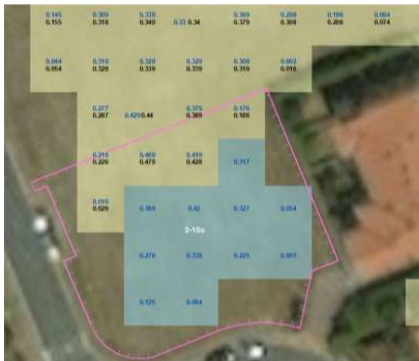
Figura 10-22: Perimetro del comparto 2-10u e indicazione delle celle di calcolo con i valori di battente (espresso in metri) nelle configurazioni di progetto (valori di colore nero) e di stato attuale (valori di colore blu).
