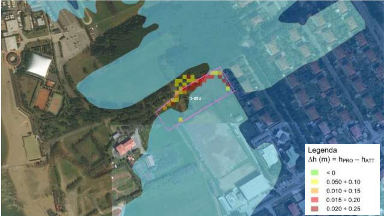
Figura 10-10: Perimetro del comparto 3-28u e indicazione delle celle di calcolo in cui si è calcolato un incremento di battente idraulico nello scenario di progetto rispetto allo scenario di stato attuale.
