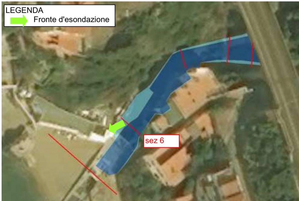
Figura 7-1: planimetria del tratto del botro Quercetano oggetto di studio con l'indicazione dei fronti di esondazione
