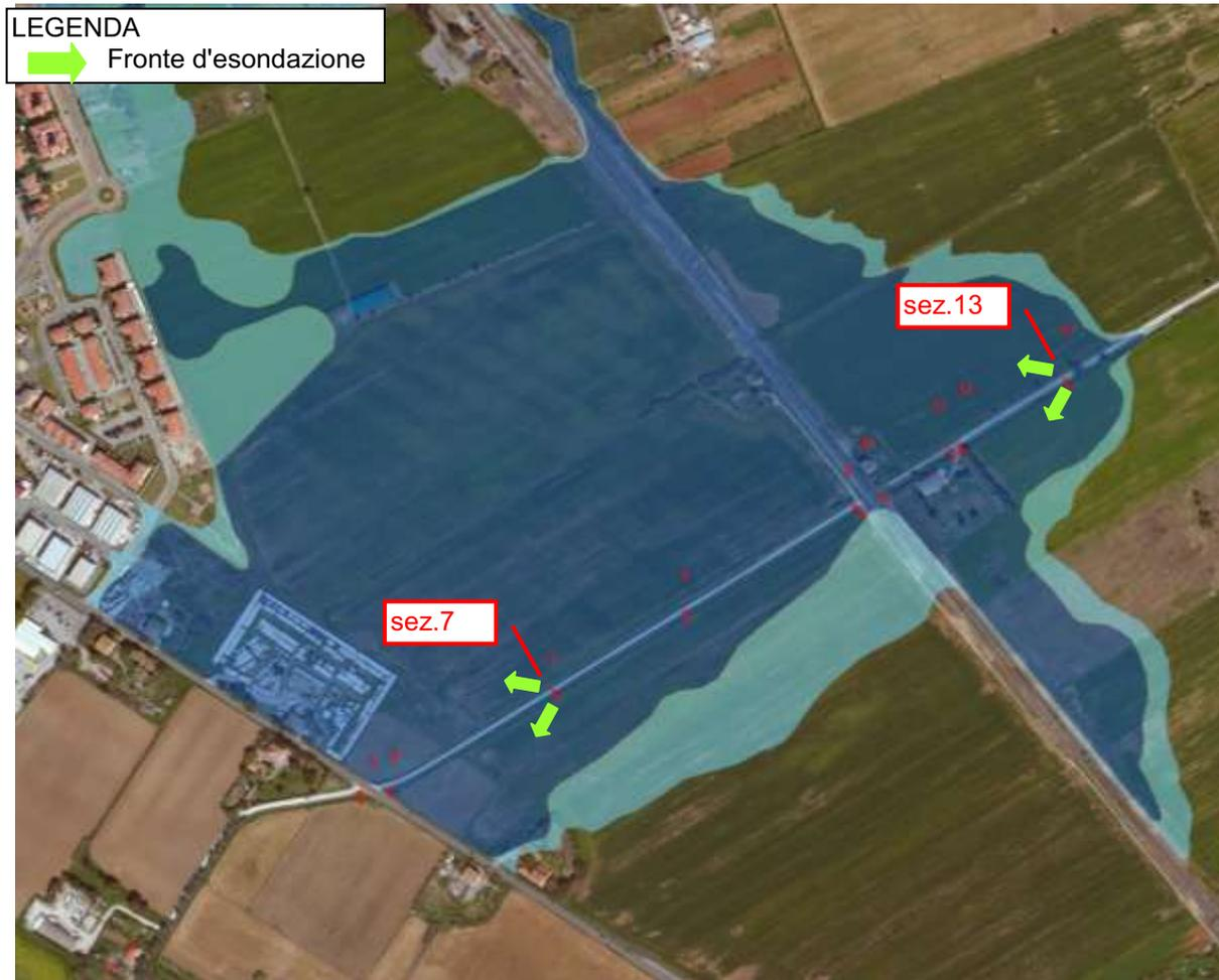
Figura 7-8: planimetria del fosso dei Fichi oggetto di studio con l'indicazione dei fronti di esondazione.
