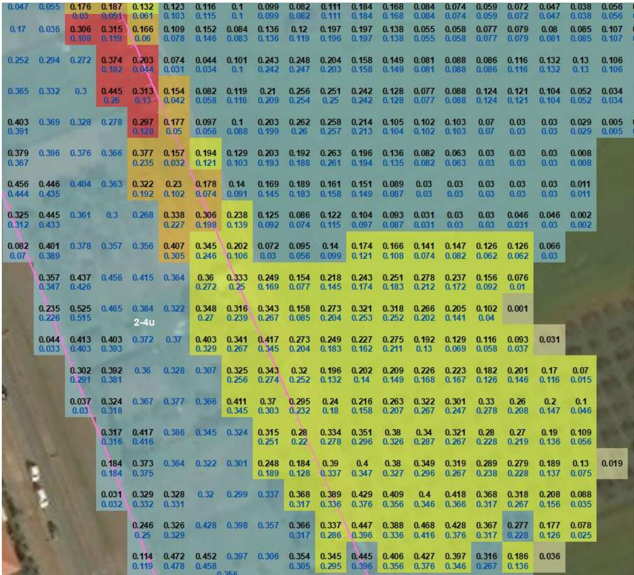
Figura 10-24: Perimetro del comparto 2-4u (Area a Sud) e indicazione delle celle di calcolo con i valori di battente (espresso in metri) nelle configurazioni di progetto (valori di colore nero) e di stato attuale (valori di colore blu).
