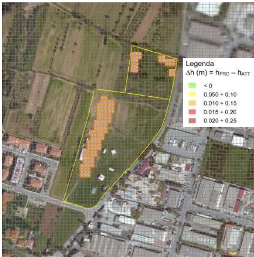
Figura 10-16: Perimetro dei comparti 3-19u e 3-30u e rappresentazione delle celle “ostruite” nello scenario di progetto per simulare la realizzazione della sopraelevazione su rilevato.
