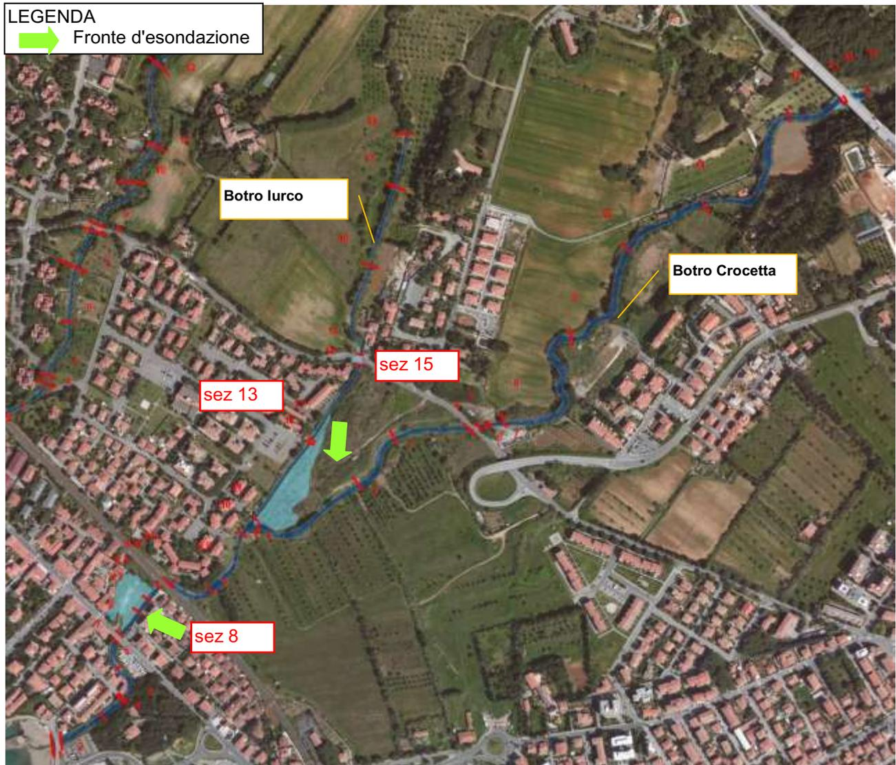
Figura 7-4: planimetria dei botri Iurco e Crocetta oggetto di studio con l'indicazione dei fronti di esondazione.
