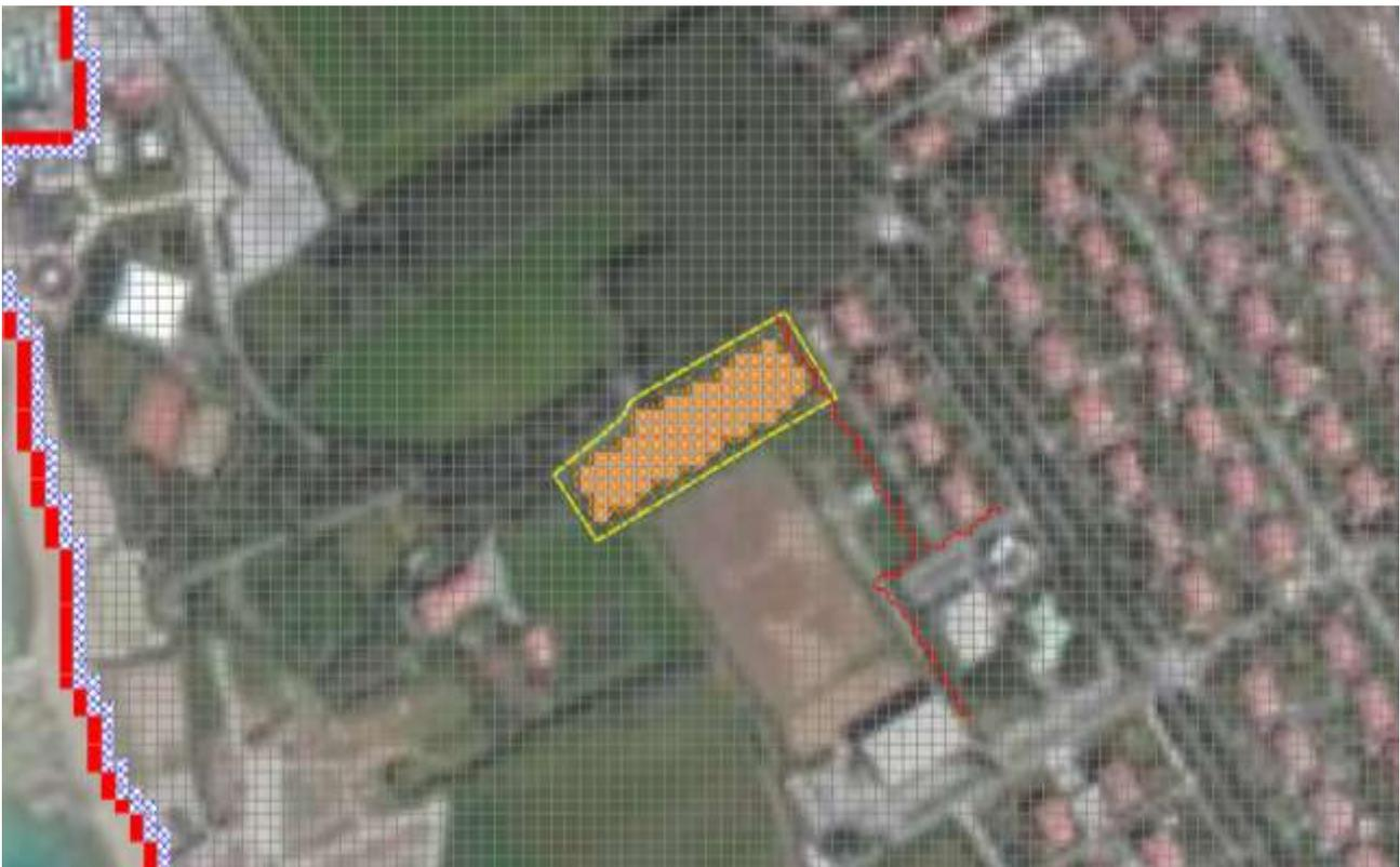
Figura 10-9: Perimetro del comparto 3-28u e rappresentazione delle celle "ostruite" nello scenario di progetto per simulare la realizzazione della sopraelevazione su rilevato.
