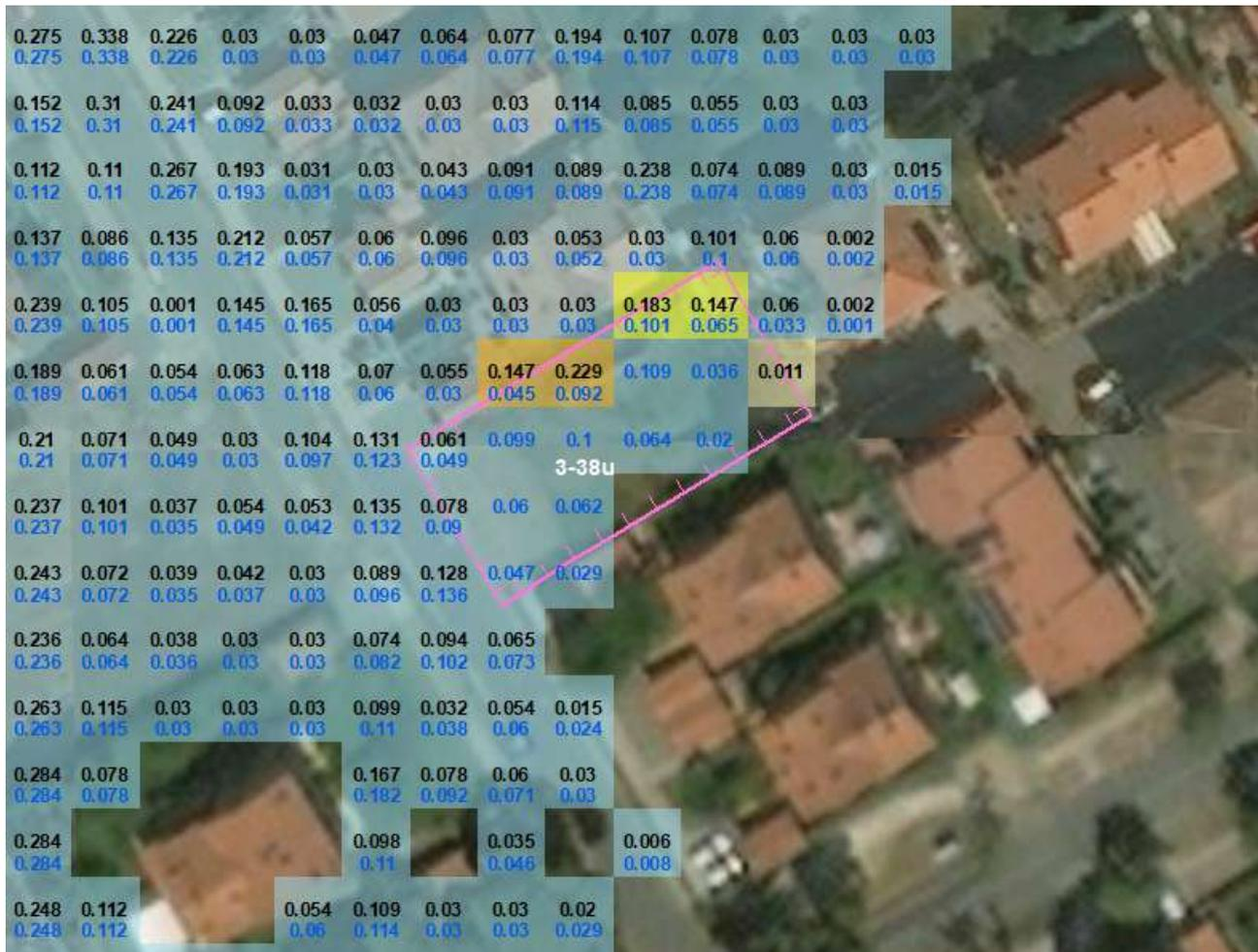
Figura 10-15: Perimetro del comparto 3-38u e indicazione delle celle di calcolo con i valori di battente (espresso in metri) nelle configurazioni di progetto (valori di colore nero) e di stato attuale (valori di colore blu).
