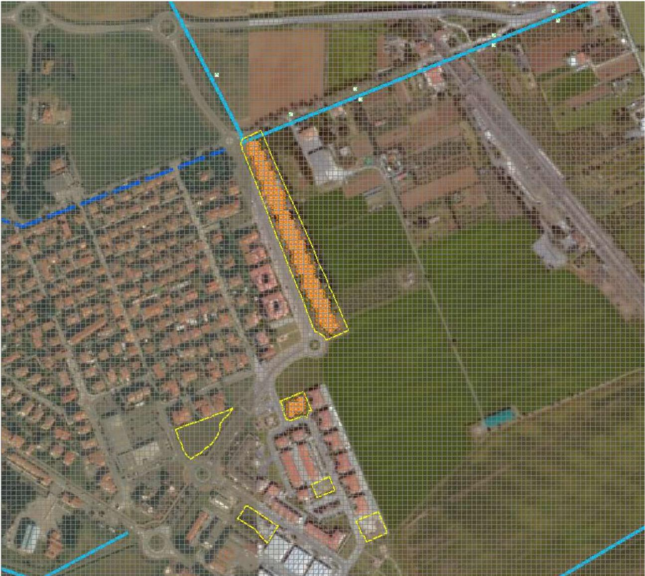
Figura 10-20: Perimetro del comparti 2-4u e 2-10u e rappresentazione delle celle "ostruite" nello scenario di progetto per simulare la realizzazione della sopraelevazione su rilevato.
