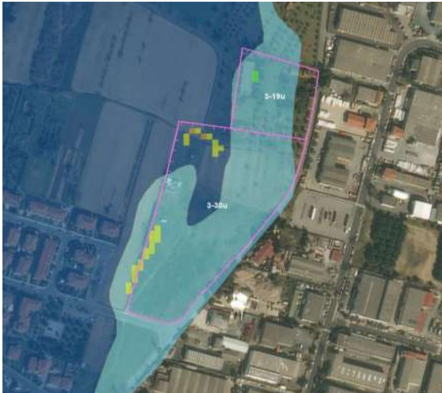
Figura 10-17: Perimetro del comparto 3-28u e indicazione delle celle di calcolo in cui si è calcolato un incremento di battente idraulico nello scenario di progetto rispetto allo scenario di stato attuale.
