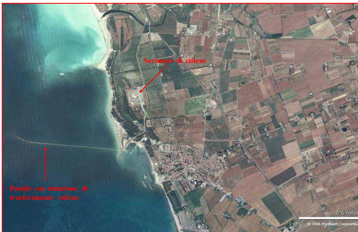
Fig. 2.2: Planimetria con indicazione del serbatoio di stoccaggio etilene e pontile con tubazione di trasferimento
