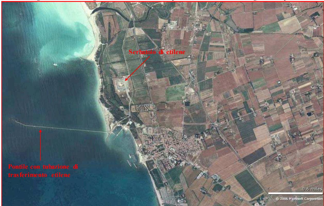
Fig. 1.2: Planimetria generale dell'area limitrofa agli impianti (tubazione di etilene e relativo serbatoio di stoccaggio)
