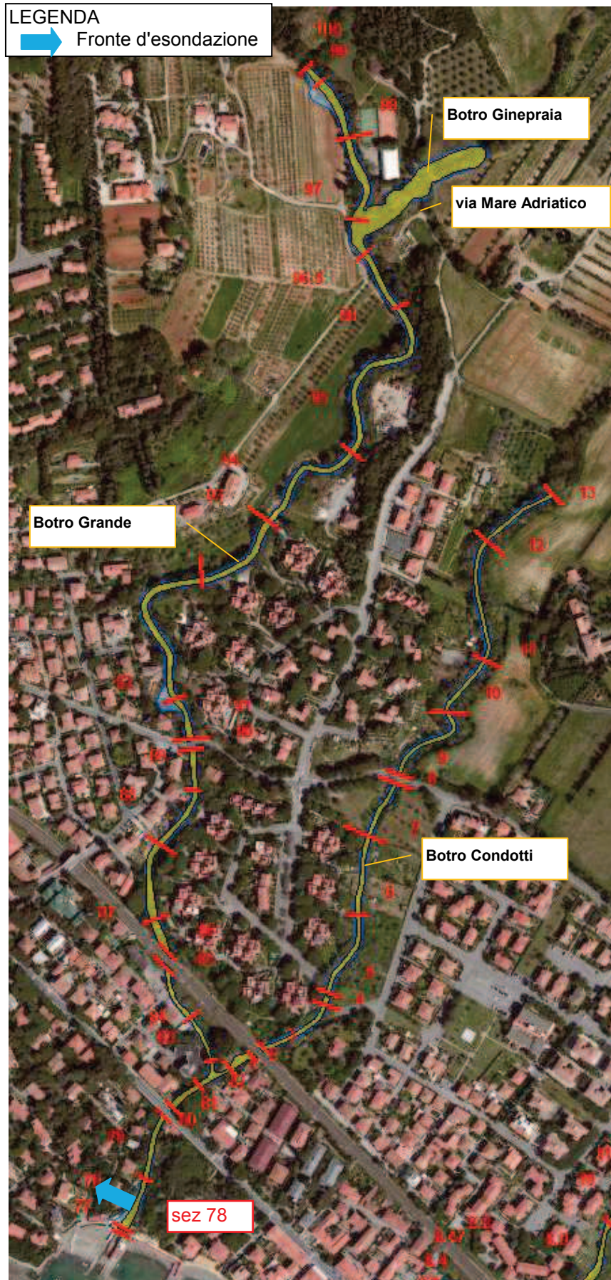
Figura 7-3: planimetria dei botri Grande e Condotti oggetto di studio con l'indicazione dei fronti di esondazione.
