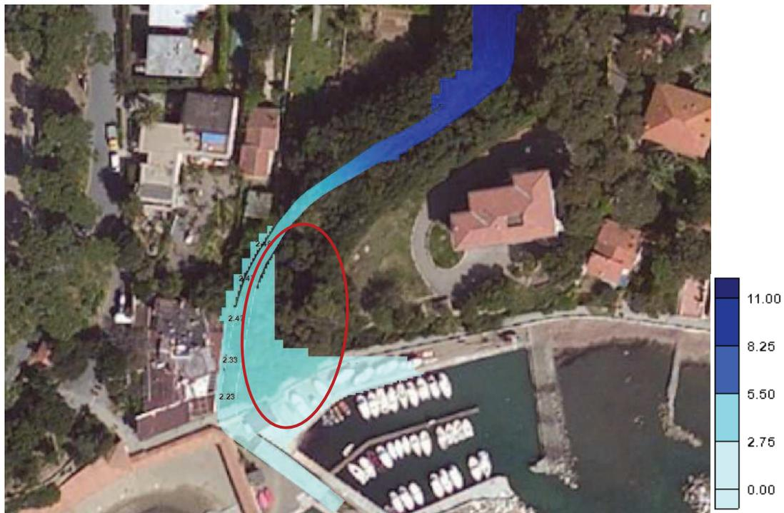
**Figura 8 Aree allagate TR200 anni – quote di esondazione in m sul l.m.m.**
