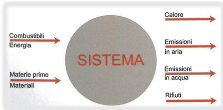
La trasformazione delle materie prime in materiali e prodotti per l'edilizia implica un consumo energetico legato ai processi industriali, al trasporto dai luoghi di produzione a quelli di costruzione, alle modalità di messa in opera.
