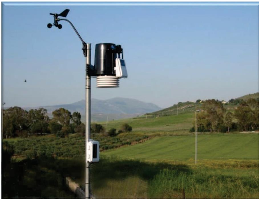
Figura: Centralina elettronica collegata a stazione metereologica
