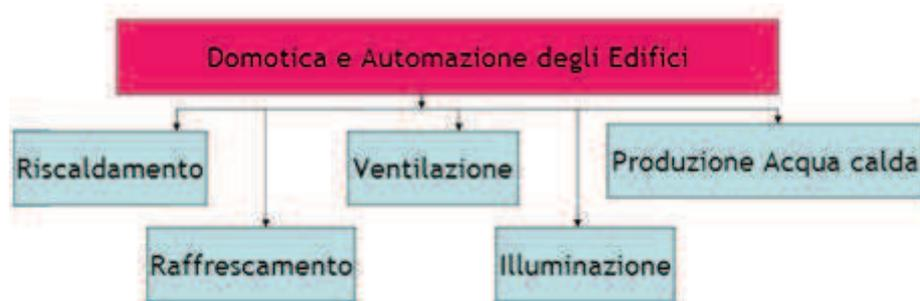
I Sistemi di Automazione hanno la funzione di massimizzare l'efficienza energetica degli impianti dell'edificio in relazione alle condizioni ambientali esterne e ai differenti e variabili scenari di utilizzo e occupazione dei singoli ambienti dell'edificio stesso, fornendo nel contempo i massimi livelli di comfort, sicurezza e qualità.
