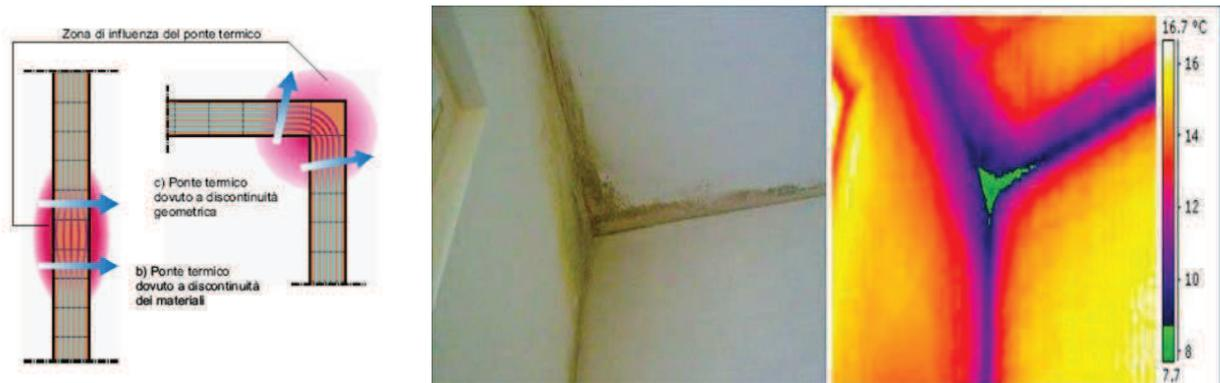
I sistemi costruttivi adottati e la progettazione dei dettagli costruttivi dovranno consentire l'eliminazione di tali elementi di discontinuità, garantendo una temperatura sufficientemente alta delle superfici interne in modo da non consentire in alcun punto di esse la formazione critica di umidità e facendo quindi in modo che le perdite di calore siano trascurabili.
